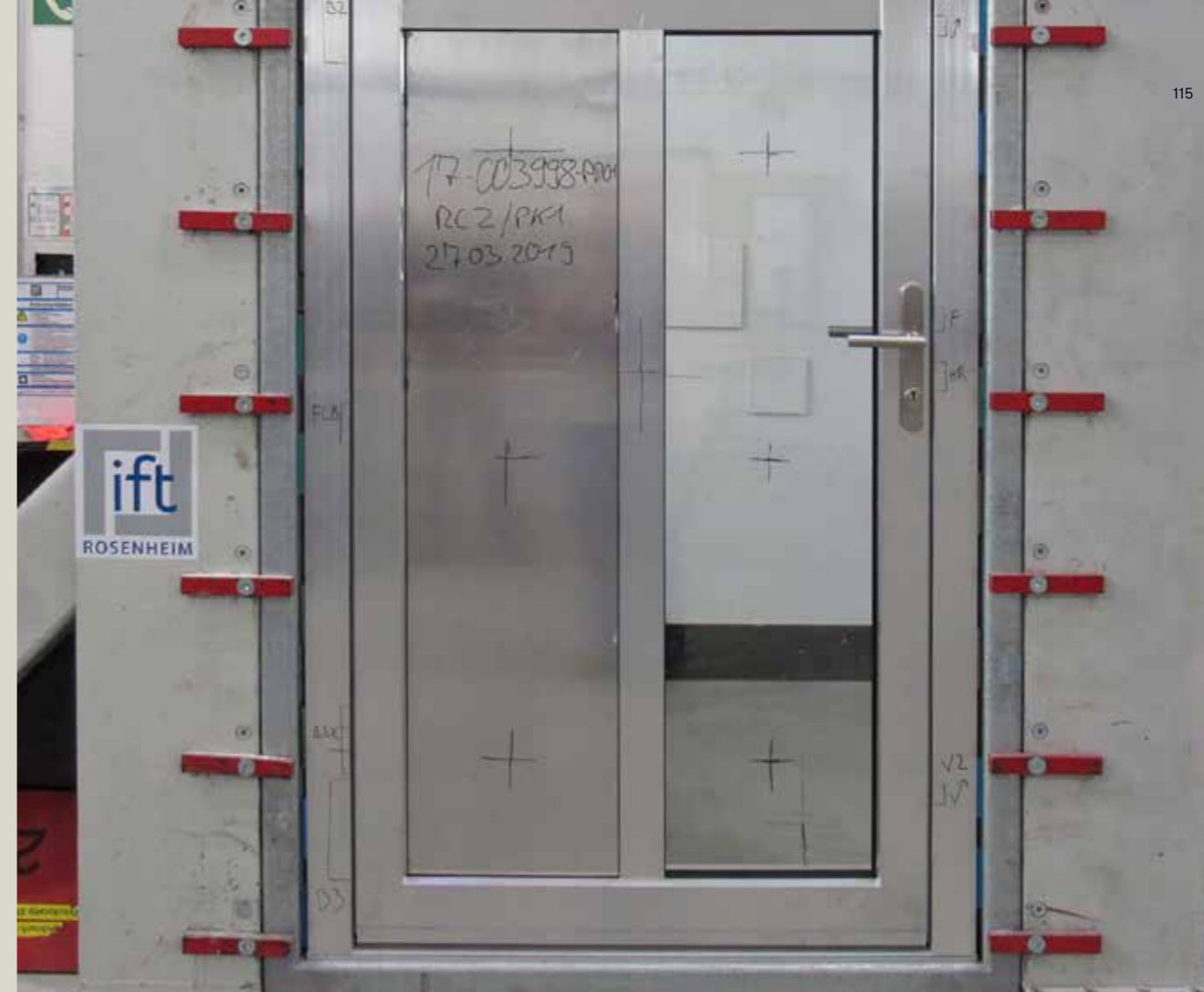
Al banco di prova l'Istituto ift di Rosenheim verifica la sicurezza antieffrazione delle porte d'ingresso.
