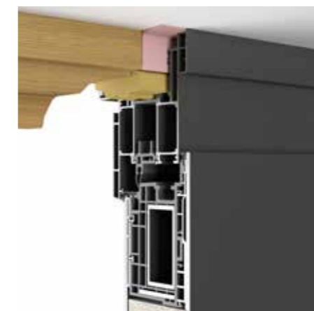
Sostituzione con rivestimento completo del vecchio telaio in legno
