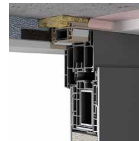
Posa in due fasi con controtelaio
