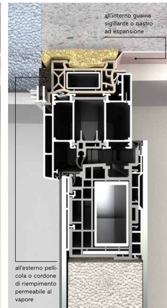
Posa in due fasi con controtelaio
